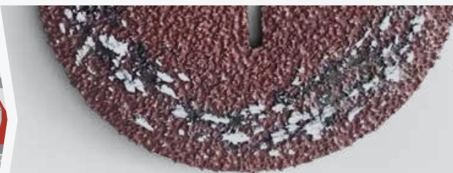
Fibrový kotouč zanesený hliníkovými třískami
